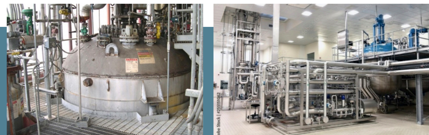
Illustration 1a et 1b : réacteur pour production par lot, ancien (à gauche) et moderne (à droite) (Source : www.aria.developpement-durable.gouv.fr ) et source : Adobe Stock)
